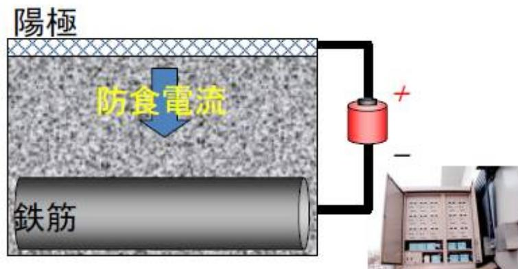
直流電源装置を用いる
