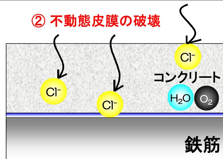
限界値以上の塩化物イオンが鉄筋近傍に到達すると不動態皮膜が破壊
