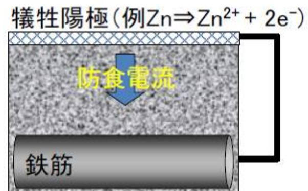
鉄筋と金属のイオン化傾向を
