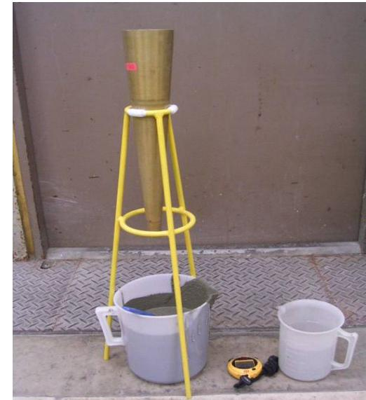
左官材、吹付け材の施工性能
