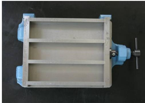
角柱供試体の型枠
