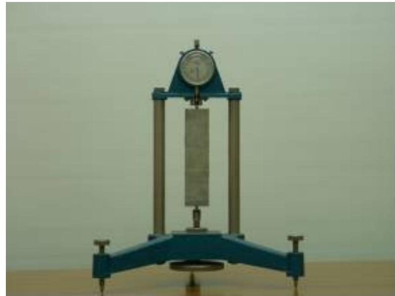
長さ変化試験の測定状況例
