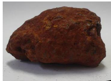
酸化鉄:鉄鉱石 $\text{Fe}_2\text{O}_3$
