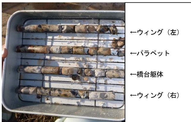
図-11 採取コアの呈色反応状況
