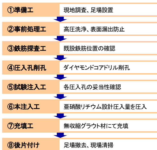
図-3 施工フローチャート
