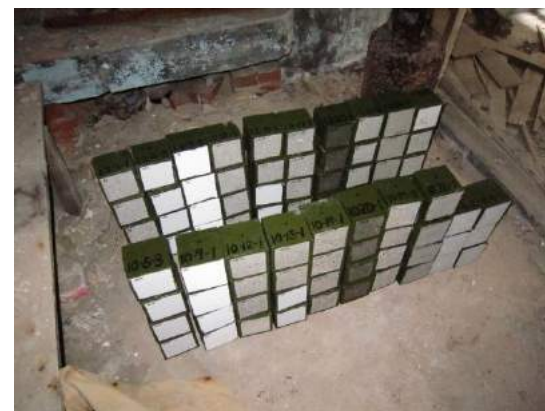
17号棟居室内 (飛来塩分がない環境)
