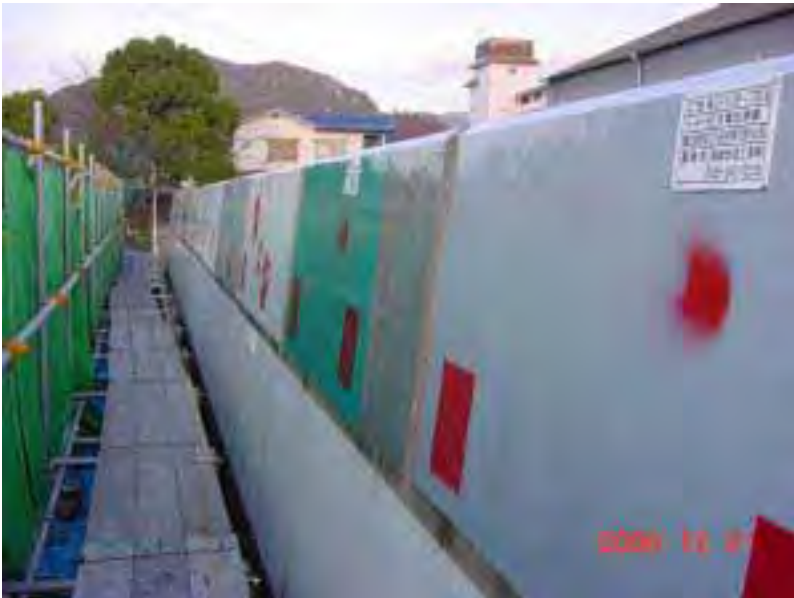
建設省中国地方建設局 中国技術事務所 落書き対策用塗料の性能試験
